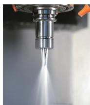
**Hinweis:** Nur das Nennmaß DCONWS kann gespannt werden, mit Kühlkanälen. Einsetzbar bis 120 bar. Um eine optimale Abdichtung zu erreichen, muss das zu spannende Werkzeug auf der ganzen Länge der geschliffenen Bohrung der Spannzange eingespannt werden.
